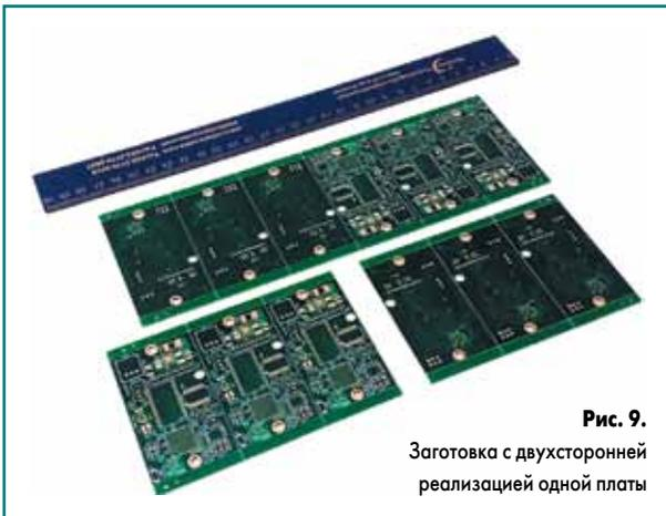
Рис. 9. Заготовка с двухсторонней реализацией одной платы
