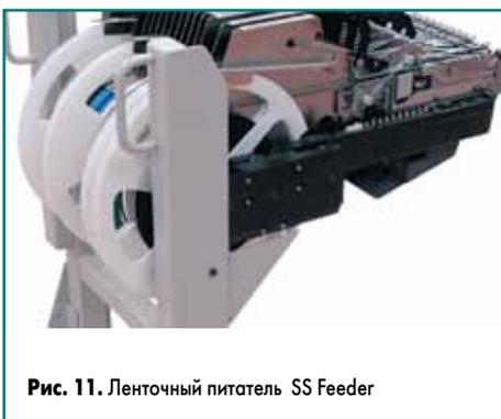
Рис. 11. Ленточный питатель SS Feeder
