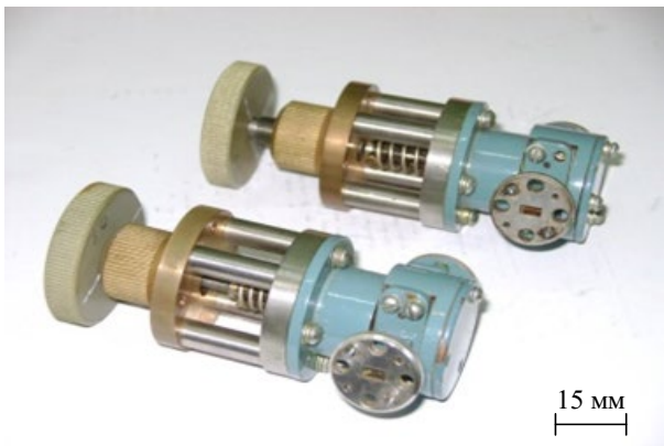
Рисунок 3 – Высокодобротные широкодиапазонные цилиндрические резонаторы проходного типа в диапазоне частот 37,50...53,57 ГГц и 53,57...78,33 ГГц
